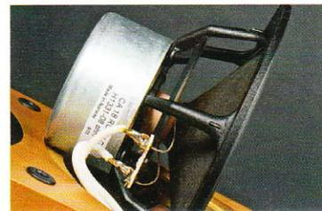
Le double bornier pour bi-amplification ou bi-câblage sert également de support au filtrage dont on remarquera la qualité des composants. Dessous, le *tweeter* et son bel aimant (d'origine Vifa) avec, à côté, l'un des haut-parleurs de grave-médium. On remarquera l'aération du *spider* et de la bobine.
