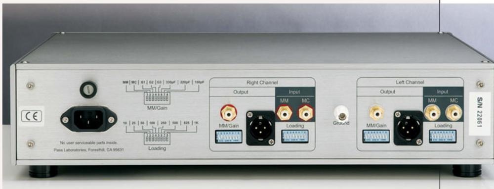
Massima configurabilità per il pannello posteriore. Sono presenti 2 coppie di ingressi RCA, marcati MM e MC, 2 coppie di uscite, una RCA e una bilanciata, e 4 banchi di dip switch, due per canale, che permettono la selezione tra MM e MC, la scelta di 3 carichi MM, la scelta di 3 livelli di guadagno per l'ingresso MC e la scelta del carico resistivo per l'ingresso MC.
