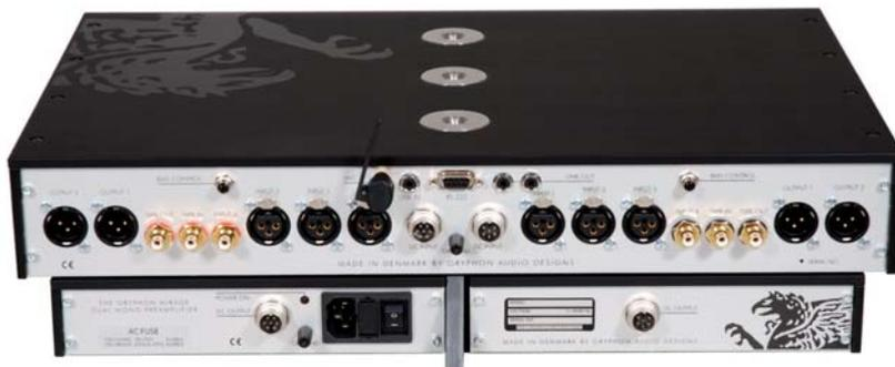
L'unità pre, sovrapposta alla sua sezione alimentatrice. E' doppio anche il circuito di alimentazione, doppie le connessioni Din tra i due blocchi, doppio il controllo di bias. Forse il più bel pannello posteriore di sempre...
