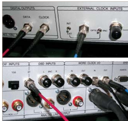
La connessione tra CDSD (sopra) e DCC2 (sotto) per mezzo dei cavi in fibra ottica in dotazione alla meccanica. Due trasmettono il clock (il nero e l'azzurro) e uno il flusso di dati (il rosso).
