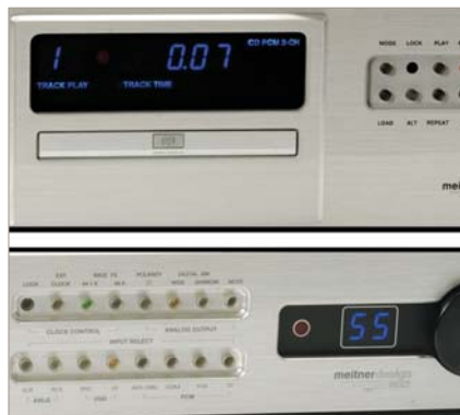
Come si presentano i pannelli frontali del CDSD (sopra) e del DCC2 (sotto) quando funzionano con il collegamento ST illustrato nella foto 2.
