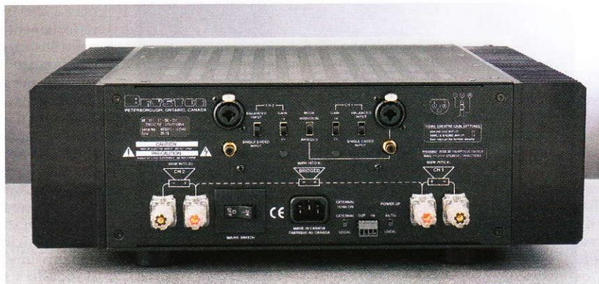
Gli ingressi bilanciati sono realizzati con i connettori Combo della Neutrik e accettano sia connettori XLR che jack da 6,3 mm. Il canale 1 diventa l'unico ingresso nella connessione a ponte, e in questa configurazione l'amplificatore eroga oltre 1000 W su 8 ohm.
