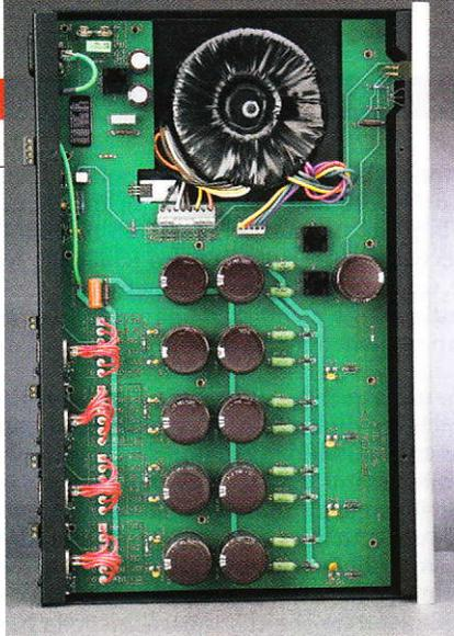
Il dimensionamento e la qualità delle sezioni di filtraggio dell'alimentatore MPS-2 sono assolutamente eccellenti.
